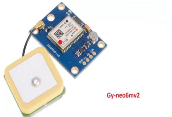
Fig. 7: GY-NEO6MV2 GPS Tracking Module
